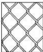
Rys. 2. Łączenie dwóch sąsiednich odcinków siatki za pomocą spirali wyplecionej z siatki i wprowadzonej w oczka siatki ruchem śrubowym (wg [6]) a) lewy odcinek siatki, b) prawy odcinek siatki
