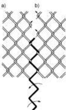
Rys. 2. Łączenie dwóch sąsiednich odcinków siatki za pomocą spirali wyplecionej z siatki i wprowadzonej w oczka siatki ruchem śrubowym (wg [6]) a) lewy odcinek siatki, b) prawy odcinek siatki
